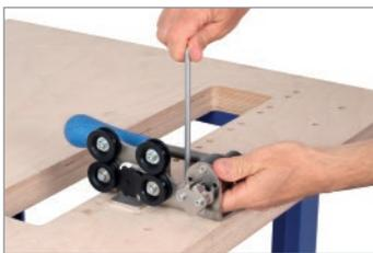
Kettenablänger auf Werkbank montieren
