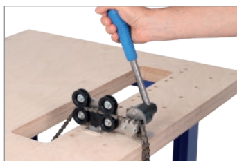
Corte la cadena Haga presión al pasador de eslabón hasta extraerlo, en caso dado ajuste el tornillo del pin
