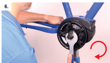
6. DE Werkzeug verwenden, dreh rechts EN use tool, turn right IT Aiutandosi con l'attrezzo apposito, girare a in senso orario NL Gereedschap gebruiken, daarmee naar rechts draaien
