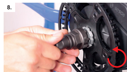
8. DE dreh links EN turn left IT Girare in senso antiorario NL Naar links draaien
