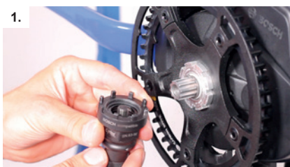
1. DE Führung einschrauben EN screw in the guide IT Avvitare il dado NL Geleiderbout indraaien
