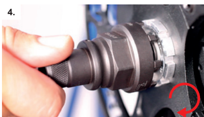
4. DE dreh rechts EN turn right IT Girare in senso orario NL Naar rechts draaien
