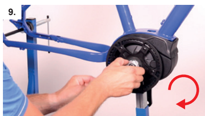
9. DE Mutter abdrehen EN remove the nut IT Svitare estraendo il dado NL Moer verwijderen
