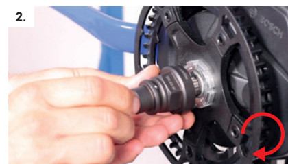
2. DE Rechtsgewinde EN right-hand thread IT Avvitare in senso orario NL Rechts-draaiend schroefdraad
