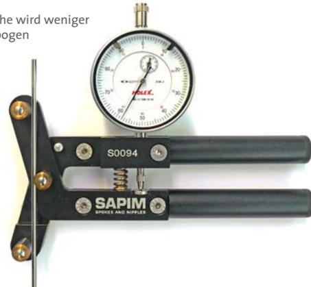
Je höher die Speichenspannung ist, umso weniger lässt sich die Speiche mit der Federkraft des Tensiometers biegen. Das bedeutet, dass bei einer hohen Speichenspannung der Messwert größer ist.
