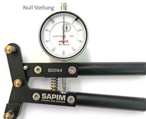
Drücken sie nun die Griffe zusammen und führen sie das Tensiometer an die Speiche, so dass die Speiche zwischen den Rollen liegt (s.Bild).
