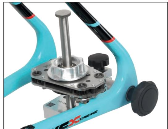
z.B. Planfräs Werkzeug montiert Flat Mount Rear
