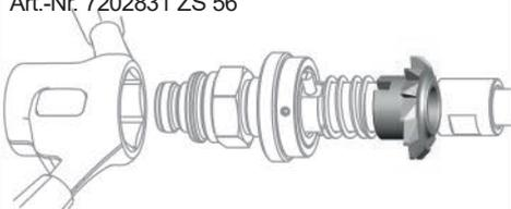
**Innenfräser Steuerrohr EC**
