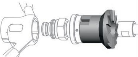
**Innenfräser Steuerrohr IS/ZS**
