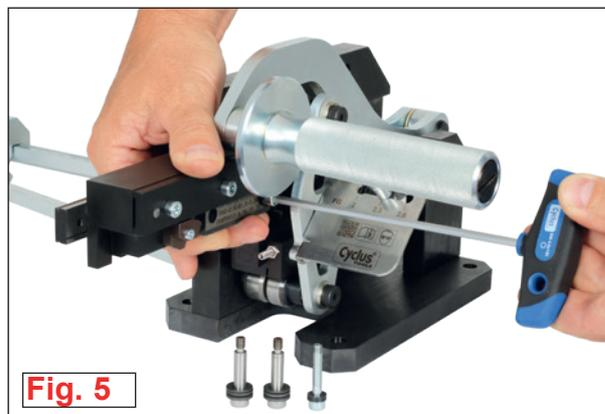
**5.** Riportare la leva manualmente nella posizione iniziale. Montare correttamente la filiera inferiore con le viti (SW 4) ed il pacchetto molla. Fare attenzione al montaggio del pacchetto molla. Applicare alla filiera inferiore una leggera pressione contro la superficie del supporto e fissarla con delle viti da 3 Nm Fig. 6
