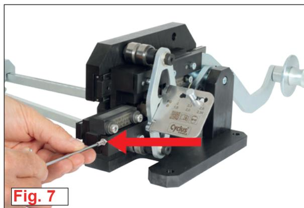
**6.** Per impostare la macchina rulla-raggi sul diametro della filettatura desiderato, si prega di leggere le istruzioni per l'uso. Con la vite di regolazione, spostare il cuneo di regolazione verso l'alto girandolo in senso orario e regolare il diametro del filetto Fig. 7. Poi stringere leggermente il controdado della vite di regolazione. Chiave di misura 8 mm. La regolazione precisa e infinitamente variabile della macchina assicura una lunga durata di vita delle matrici di laminazione.
