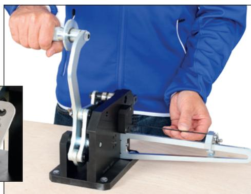
**6.** Walzmaschine mit geeigneten Schrauben sicher auf waagerechter Arbeitsplatte montieren
