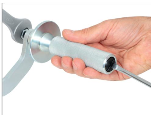
**5.** Griff montieren, Kontermutter festziehen
